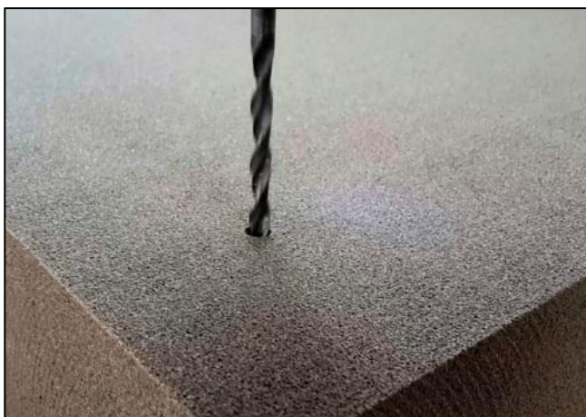
Рисунок 5 – Изготовление отверстий в плитах пеностекла НЕОПОРМ® методом сверления
