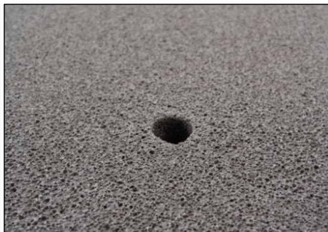
Рисунок 5 – Изготовление отверстий в плитах пеностекла НЕОПОРМ® методом сверления
