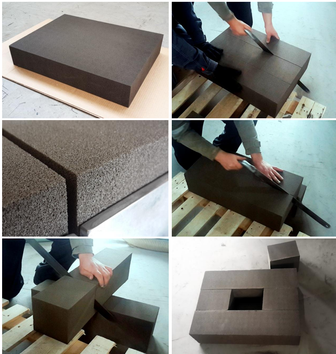
Рисунок 6 – Распиливание плит пеностекла НЕОПОРМ®
